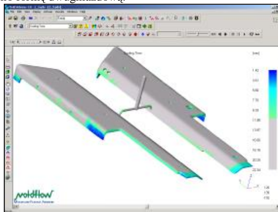
Rys. 6. Rozkład czasu chłodzenia wypraski w momencie zastygnięcia przewężki.
